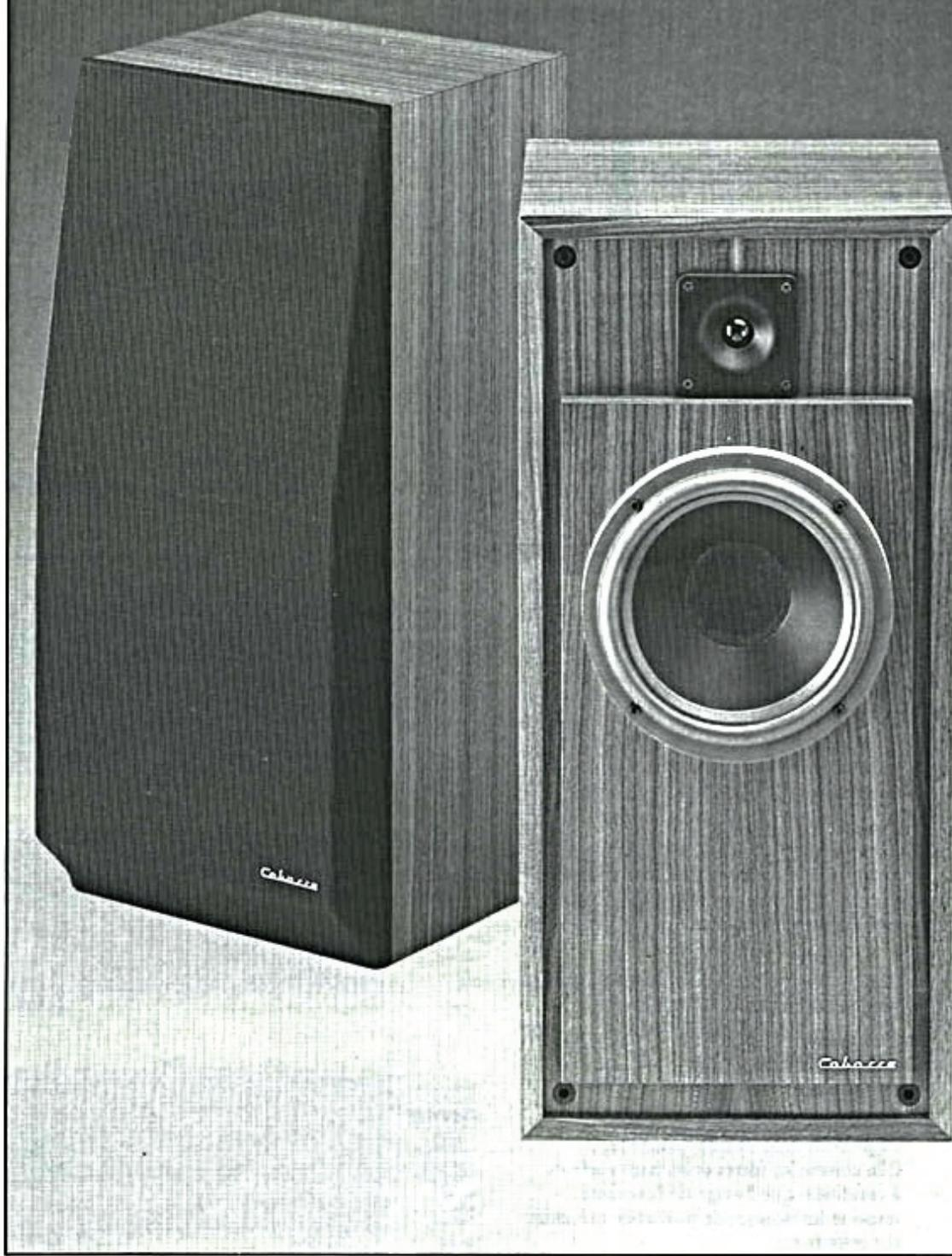
**L**a Frégate est un système à deux voies équipé dans les graves d'un haut-parleur de 21 cm en mousse synthétique rigide. Cette nouvelle membrane révolutionnaire permet au haut-parleur 21 M 18 d'éviter la distorsion inhérente aux membranes en pulpe de cellulose, avantage tellement considérable qu'il est non seulement mesurable mais audible. L'enceinte a été calculée pour optimiser ce haut-parleur de façon à obtenir le meilleur rendu des fréquences graves en fonction du volume de l'enceinte.
